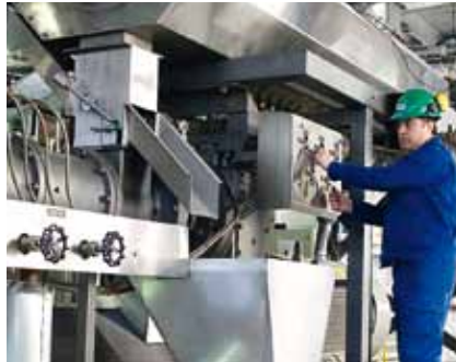
Fiskefôrpellets produseres på en ekstruderlinje.
